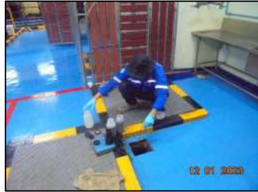
รูปที่ 3.2-1 จุดตรวจวัดคุณภาพน้ำทิ้ง บริเวณบ่อแยกกรวดทราย (Aerated Grit Chamber)
